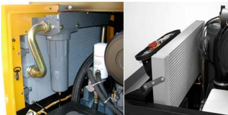
Дополнительные воздушные **фильтры PD** и **QD** устанавливаются в основной. Это способствует получению более качественного и чистого воздуха. Применяется при работах с пескоструйным инструментом.
